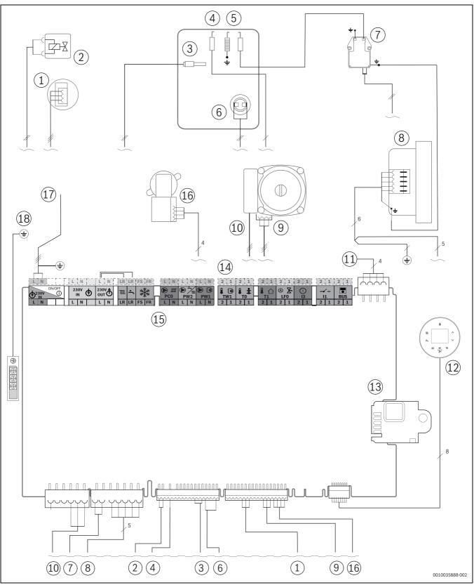
Fig. 114 Electrical wiring
