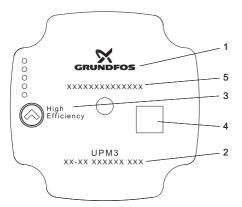
Fig. 5 Nameplate: Grundfos standard
